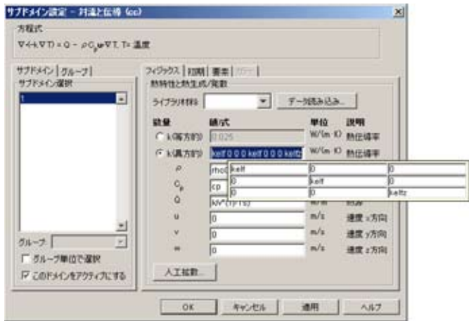
[図2] 異方性特性はダイアログボックスの対応するフィールドに入力します。温度の任意関数が入力することができます。
