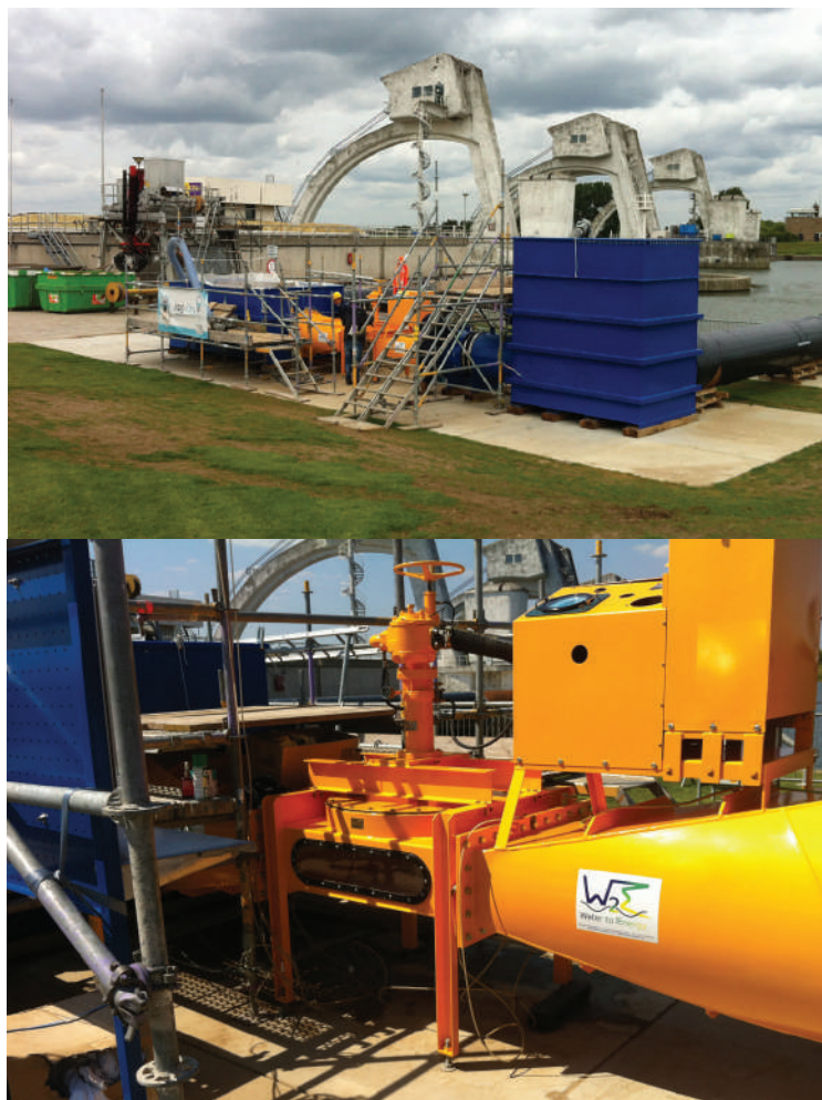
図 7 実機テストを間近に控えた Water2Energy 社の水力タービンプロトタイプ。
