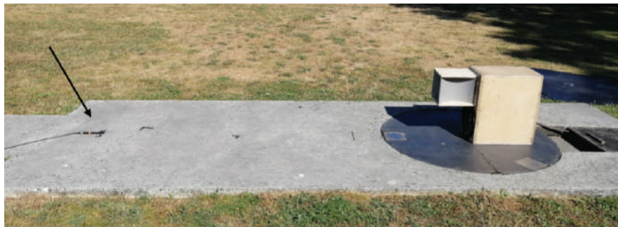
図3 音響損失測定のための屋外測定セットアップ。矢印はマイクロホンの位置を示す。
