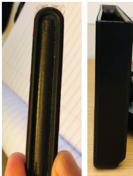
図 5 極薄マイクロトランスデューサー(左)と厚さ1インチの極薄DAES(右)のプロトタイプ。
