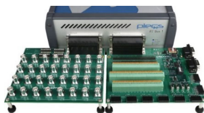
別売の アナログブレイクアウトボード と デジタルブレイクアウトボード を接続した場合
