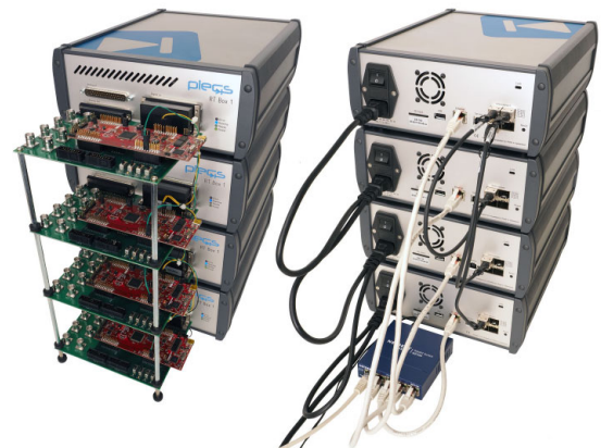
4台のRT-Boxを使用した系統連系モジュールマルチレベルコンバータ (MMC) のリアルタイムシミュレーション環境
