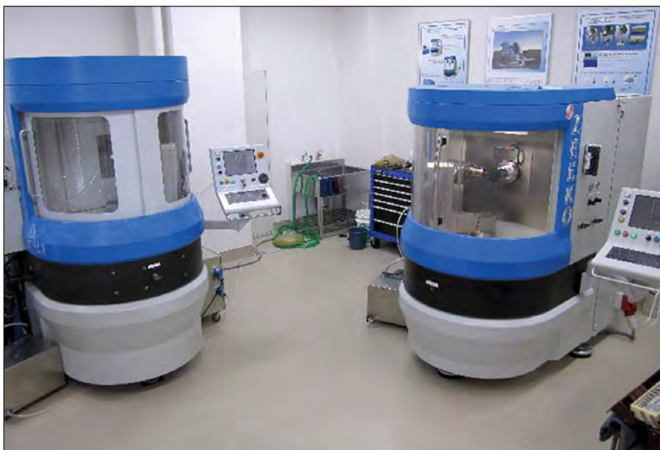
図 2. Zeeko 社のインテリジェンスロボット研磨機 FJP ツールの配置と圧力は、Zeeko 7 アキシス CNC (Computer Numerical Control: コンピュータ数値制御) のツールコントローラにより管理されます。
