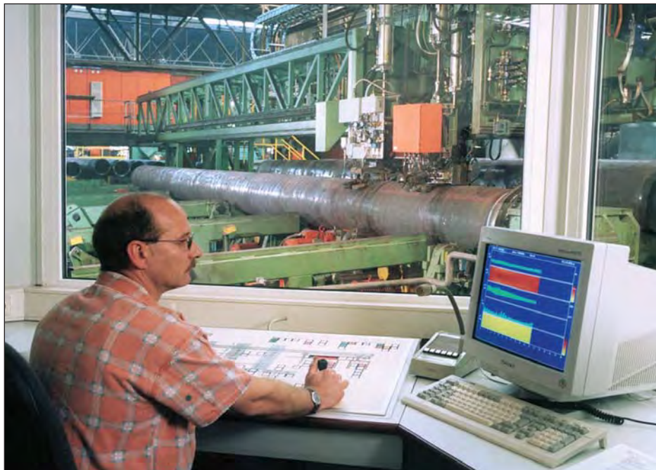
図 2. 検査作業中:ヨークはオレンジ色のボックスの後ろのプラスチックの中に組み込まれており、スチールパイプが回転しているとき、このボックスはスチールパイプにそって、表面の 1 ミリ上を動きます。
