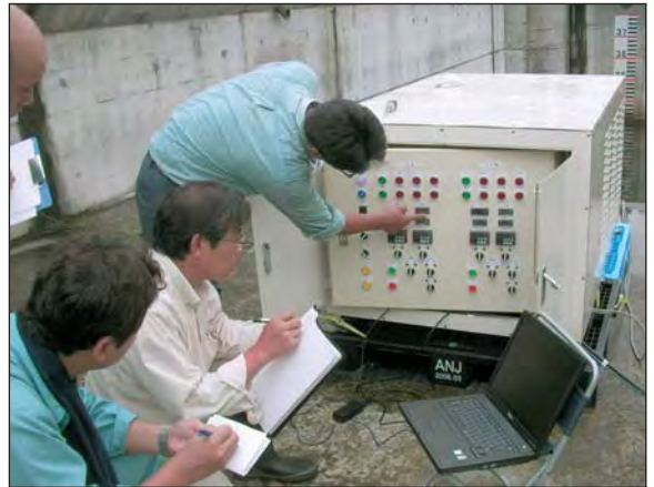
図5 現地での微細気泡生成装置
