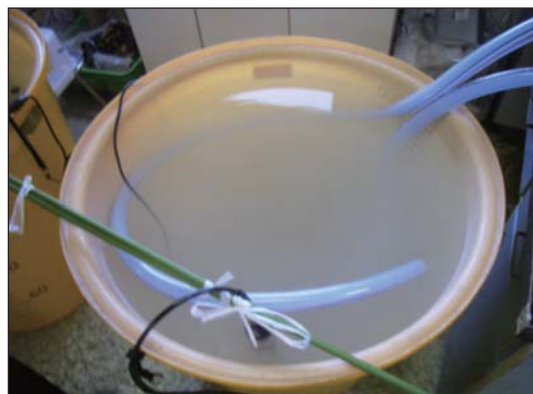
図2 微細気泡を含む水。乳白色に見える。
