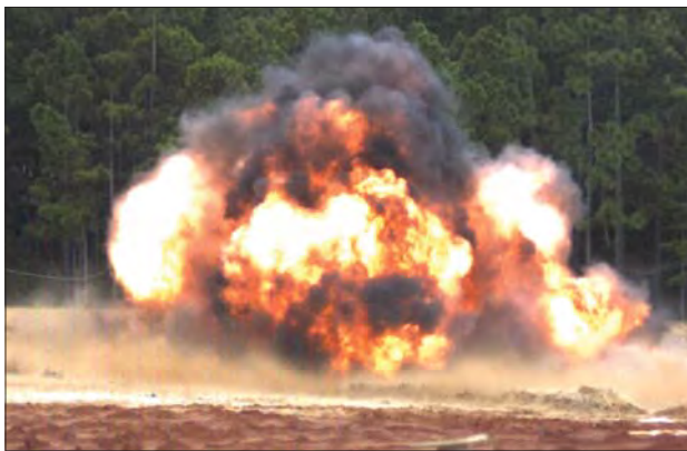
図5. キャリブレーション実験における、100ポンドのANFO爆弾の地表における爆発
