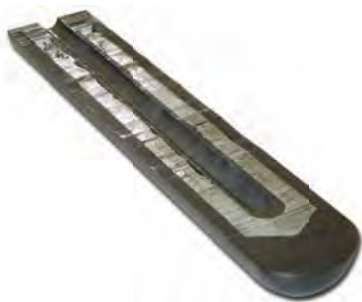
図1：一般的な定点セルの断面図。黒鉛容器で、金属インゴットが確認できる。温度計挿入箇所の溝が中央にある。
