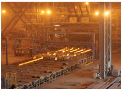
図 1. 連続鋳造法の排出テーブル。凝固ストランドが切断、排出されています。
