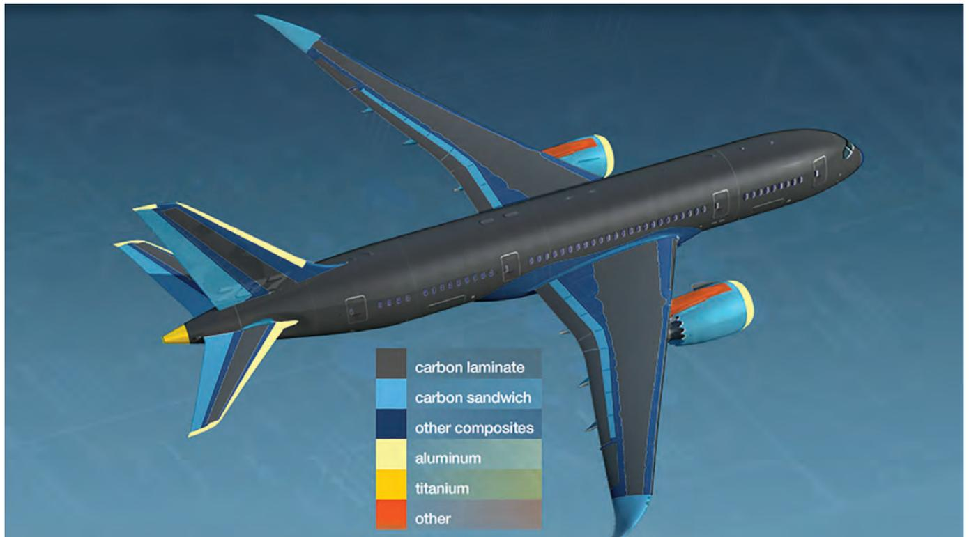
図 1. ボーイング 787 では、航空機全体の 50% 以上に最先端複合材料を使用している<sup>1</sup>。
