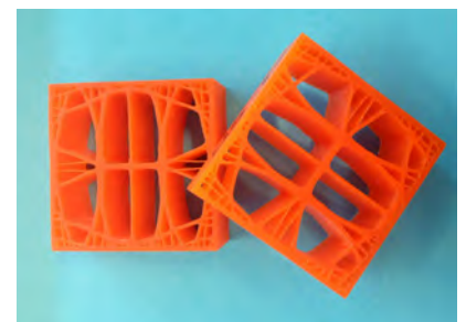
図 1. 上：ユニット・セルのジオメトリ中：ある方向では僅かな歪みを生じながら、水平方向で最適化された設計の機械的応力を示すシミュレーション結果 下：3D プリンタによって作成されたサンプル
