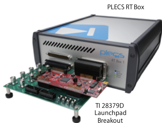
図8: HIL検証のハードウェアセットアップ
