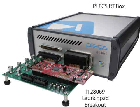
図7: HIL検証のハードウェアセットアップ
