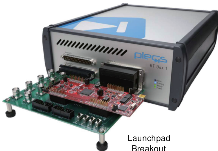
図9: RT BoxによるHIL検証のハードウェアセットアップ PLECS RT Box
