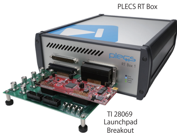
図8: RT Boxを使用したHIL検証のハードウェアセットアップ
