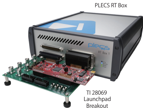
図6: HIL検証のハードウェア設定
